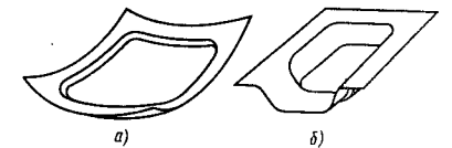
Рис. 12. Примеры неразвертывающейся прижимной поверхности:
