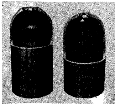
Рис. 11. Разрушение кромки алюминиевой заготовки при обжиме с внешним противодавлением
